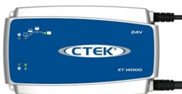
LE XT 14000 EST UN CHARGEUR DE BATTERIE **24V** PROFESSIONNEL SPÉCIALEMENT CONÇU POUR LA CHARGE ET LA CHARGE D'ENTRETIEN DES BATTERIES 24V DANS LES VÉHICULES. LE XT 14000 EST UN CHARGEUR ENTIÈREMENT AUTOMATIQUE À 7 ÉTAPES QUI DÉLIVRE 14 A POUR LES BATTERIES 24 V DE 28 À 300 AH ET CONVIENT À LA CHARGE D'ENTRETIEN JUSQU'À 500 AH.
